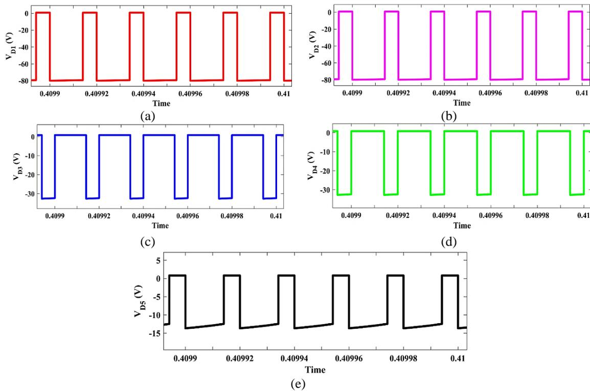
Figure 7. Voltage waveforms of SI and SC diodes (a)  $V_{D1}$ , (b)  $V_{D2}$ , (c)  $V_{D3}$ , (d)  $V_{D4}$ , and (e)  $V_{D5}$
